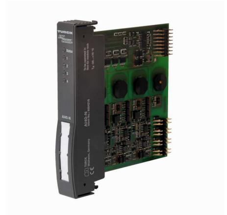
Модуль аналоговых входов AI40-N служит для подключения двухпроводных датчиков (активный вход = режим источника / датчик пассивный) и 4-х проводных датчиков (пассивный вход = режим приемника / датчик активный).
