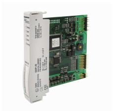
Шлюз GDP-IS служит для подключения excom® для сетей PROFIBUS-DP. Подключение к PROFIBUS-DP может быть организовано через оптоволоконный или медный кабель. При использовании оптоволокна для передачи данных коммутационная пара должна быть встроена между медной линией и оптоволокном подключенным к PROFIBUS, которая также адаптирует уровень к IS слою. При использовании медных кабелей коммутатор сегмента (RS485-IS коммутатор) должен быть установлен с обеспечением условий взрывозащиты.
