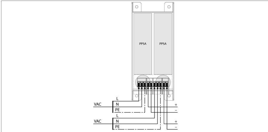
Преобразователь переменного тока в постоянный PPSA230Ex полностью обеспечивает питанием систему excom®. Комбинированная взрывозащита Ex m и Ex e позволяет применение в зоне 1. Он также полностью залит компаундом и смонтирован в литом алюминиевом корпусе.
