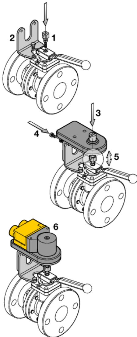
Завинтите самопорящуюся гайку на винт привода и затем винт поводка в ручной клапан.
