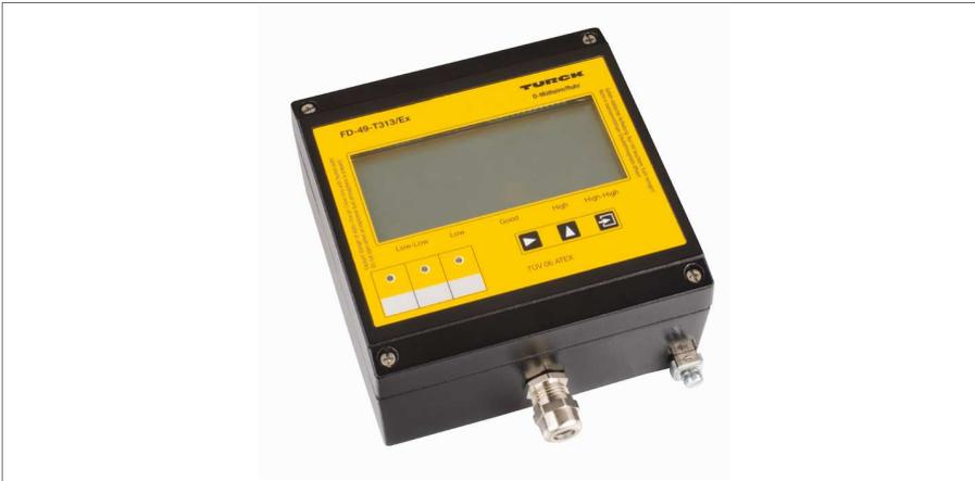
3-канальный цифровой индикатор FD-48-T317/EX отображает информацию о процессе узлов шины PROFIBUS-PA.
