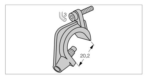
Комплектующие для монтажа магнито-индуктивных датчиков на профильные цилиндры, диаметром 32...100 мм; цинк, литье под давлением
