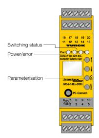
Одноканальный температурный измерительный преобразователь IM34-14Ex-CDRi служит для работы с термосопротивлениями (RTD) Ni100/Pt100, термопарами типа В, Е, J, K, L, N, R, S и линеаризации выходного токового сигнала температуры 0/4...20 мА. Также возможно подключение резисторов, потенциометров или источников низкого напряжения для линеаризации сигналов в диапазоне -160...+160 мВ.
