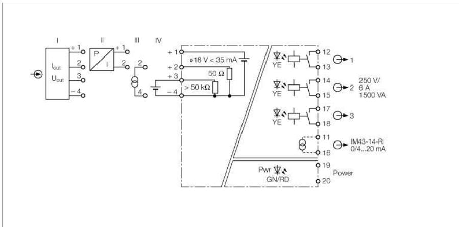
Модуль контроля предельного значения IM43-14-RI - это одноканальное устройство, контролирующее недостаточное значение/превышение заданных значений тока 0/4...20 мА или напряжения 0/2...10 В.
