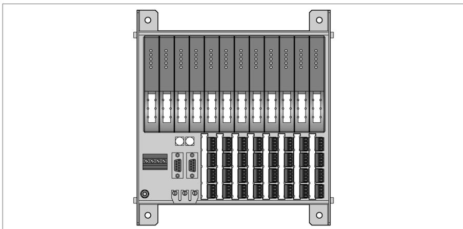
Модульная стойка MT08-N состоит из системной платы и системы полозьев для установки модулей (корзины для модулей). Можно установить 1 шлюз, 1 блок питания и 8 модулей ввода/вывода. Могут быть подключены до 64 дискретных входов/выходов или 32 аналоговых или в смешанном варианте.
