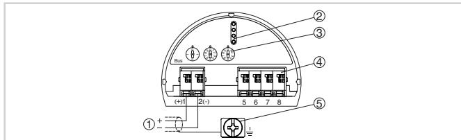
Отсек электроники и подключения (однокамерный корпус)
