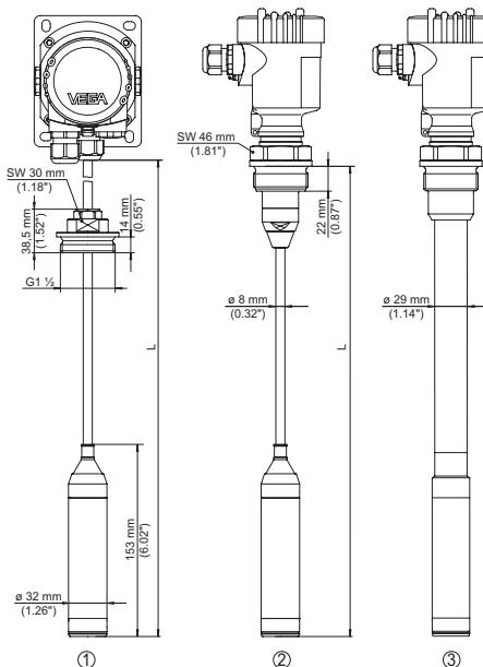
1 Исполнение с несущим кабелем и резьбовым соединением G1½ A
