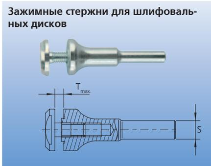
Принадлежности для установки шлифовальных дисков в прямошлифовальных машинах. Надежное исполнение от PFERD с высокопрочным хвостовиком.
