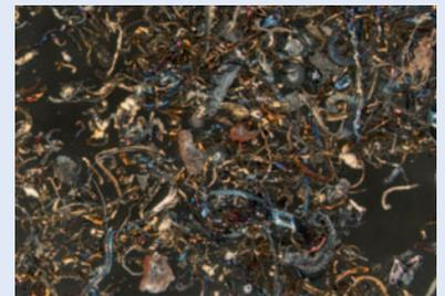
Такую стружку производят обдирочные и лепестковые шлифовальные круги. Окрашивание в синий цвет происходит вследствие перегрева.
