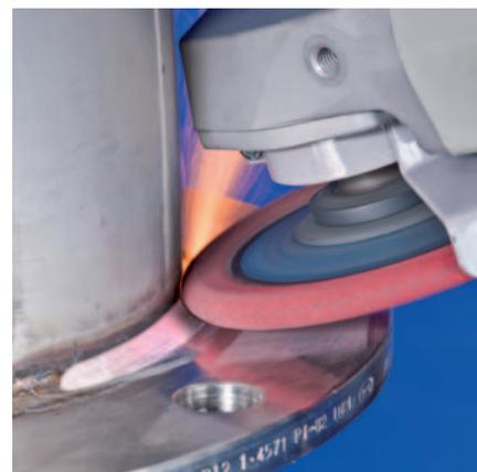
Высокопроизводительный инструмент SGP CO-CURVE с высокой производительностью съема. Для сложных задач шлифования, особенно для создания равномерных поверхностей.
