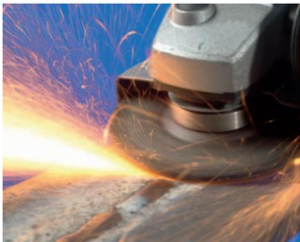
Профессиональный инструмент твердости R с высокой степенью шлифования и очень хорошей стойкостью. Для применения в условиях повышенных нагрузок.
