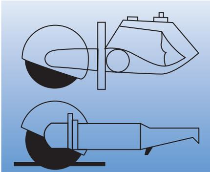
Специальный инструмент твердости R с высокой производительностью и хорошей стойкостью для работы на ручных абразивно-отрезных станках (круги диаметром 300–350 мм).
