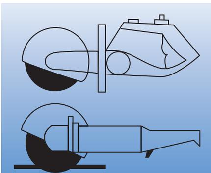
Специальный инструмент твердости Q с высокой производительностью и хорошей стойкостью для работы на ручных абразивно-отрезных станках (круги диаметром 300–350 мм)
