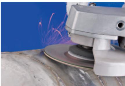
Исполнение INOX для очень хорошей производительности съема при обработке деталей из высококачественной стали (INOX).
