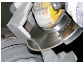
Для удаления литейной прибибы, литевowego прилива, расслоений или заусенцев на литых деталях из серого или высокопрочного чугуна (GG/GGG bzw. GJL/GJS) также подходят алмазные шлифовальные отрезные круги на гальванической связке. Они характеризуются максимальной стойкостью, оптимальной резкой глубоколежащих обрабатываемых мест (обусловлено постоянным диаметром инструмента), а также комфортной и быстрой обработкой грубой поверхности отливки.
