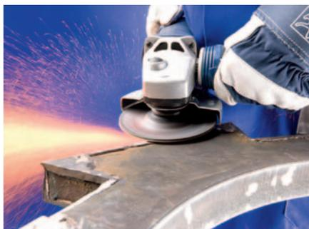
Интегрированная стекловолоконистая несущая основа для работы с твердыми и грубыми поверхностями, а также для обработки кромок.
