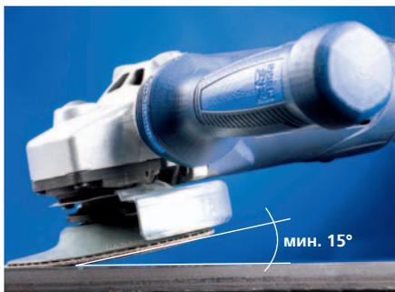
До настоящего времени: Использование обычных фибровых шлифующих инструментов
