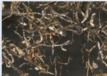
POLIFAN®-STRONG-FREEZE производит длинную стружку. Благодаря незначительной термической нагрузке не происходит окрашивание в синий цвет.
