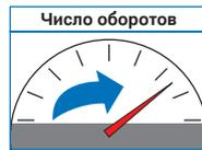
Количество оборотов n означает число оборотов в минуту [об/мин]. Необходимое количество оборотов рассчитывается из скорости резания V в метрах в минуту [м/мин] или в метрах в секунду [м/с] диаметром инструмента  $d \times \pi$  (3,14).
