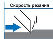
Скорость резания – это скорость, с которой реж. кромка инстр. производит врезание в обр. материал и произв. стружка.
